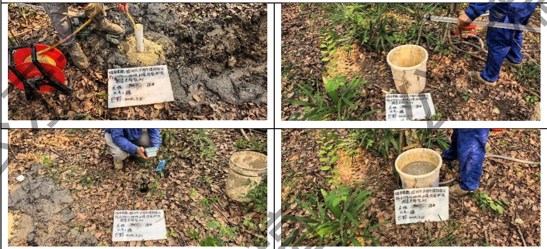
△DW01 成井洗井
